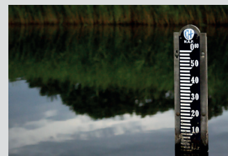
Het waterpeil wordt in Nederland meestal aangeven met het Nieuw Amsterdams Peil, oftewel NAP.
